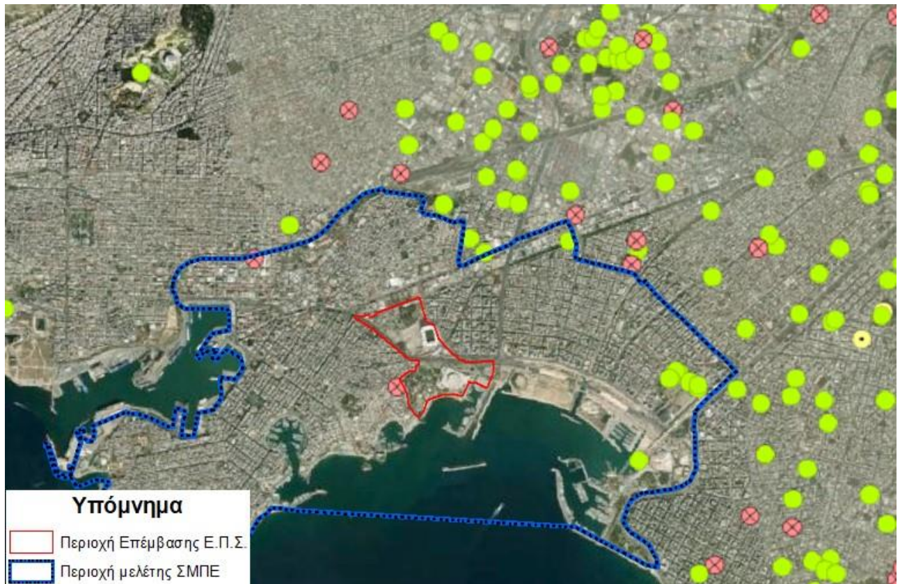
Εικόνα 6.5-5: Σημεία υδροληψίας στην περιοχή μελέτης και στην περιοχή επέμβασης του ΕΠΣ. Με πράσινο χρώμα συμβολίζονται οι ενεργές γεωτρήσεις (ή πηγάδια), με κόκκινο οι ανενεργές και με κίτρινο αυτές που είναι άγνωστο το καθεστώς λειτουργίας τους.
