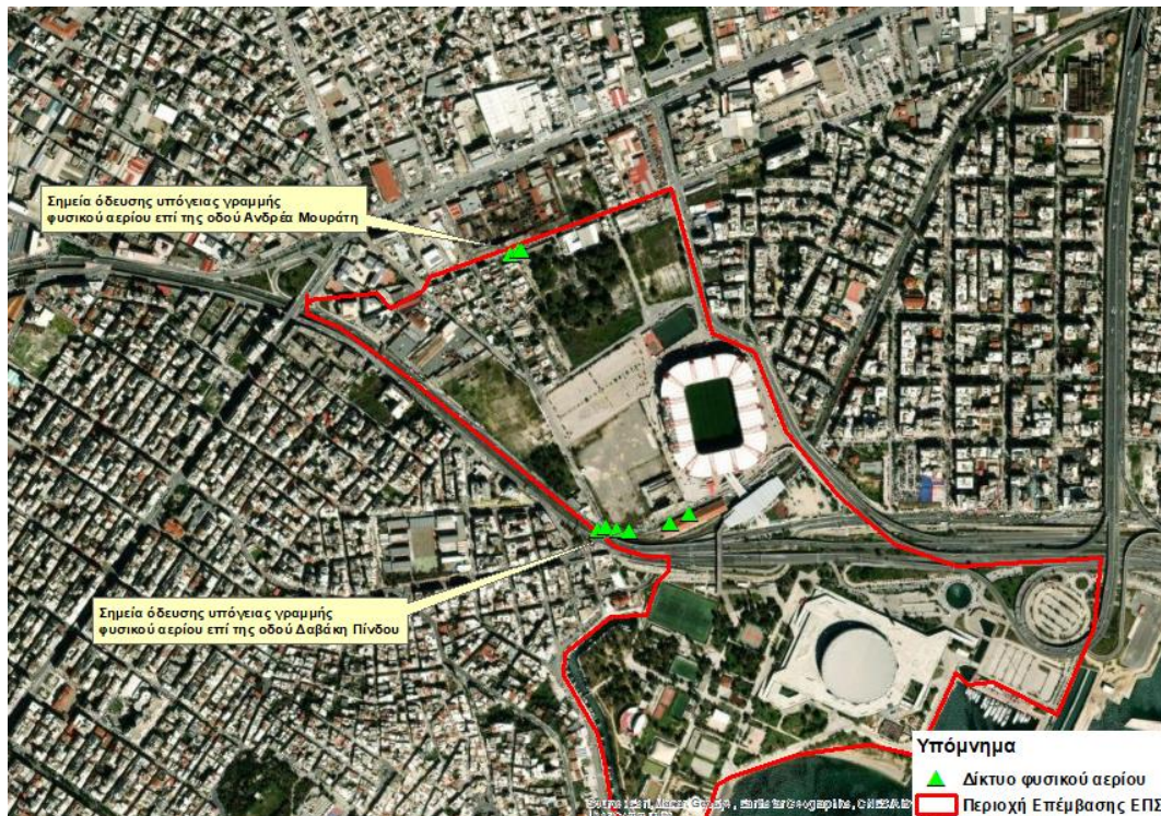
Εικόνα 6.4-13: Σημεία όδευσης υπόγειου αγωγού φυσικού αερίου εντός της περιοχής επέμβασης του ΕΠΣ
