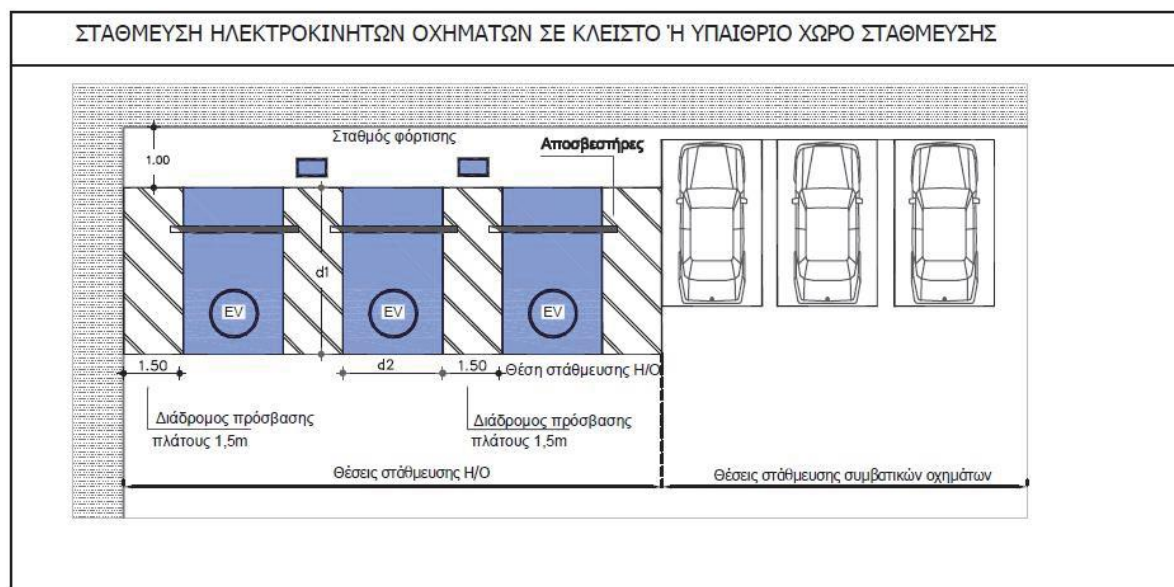
Εικόνα 4 Ενδεικτική χωροθέτηση θέσεων στάθμευσης και σταθμών επαναφόρτισης σε κλειστό ή υπαίθριο χώρο στάθμευσης
